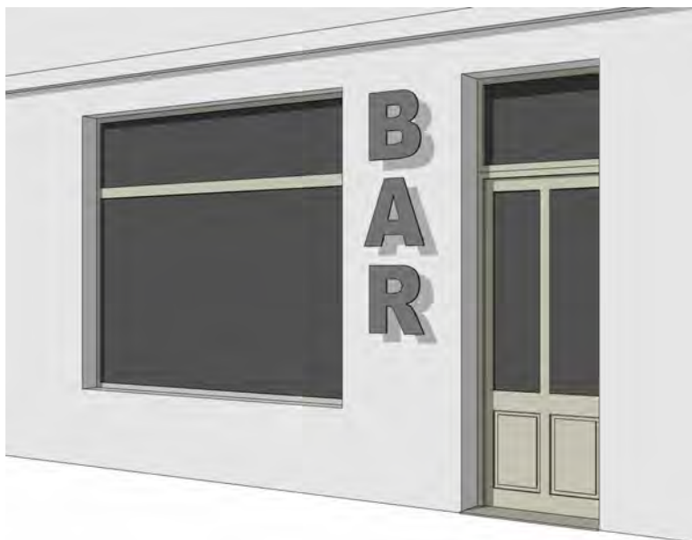
Rys. Odmiana szyldu pionowego z liter odsadzonych
