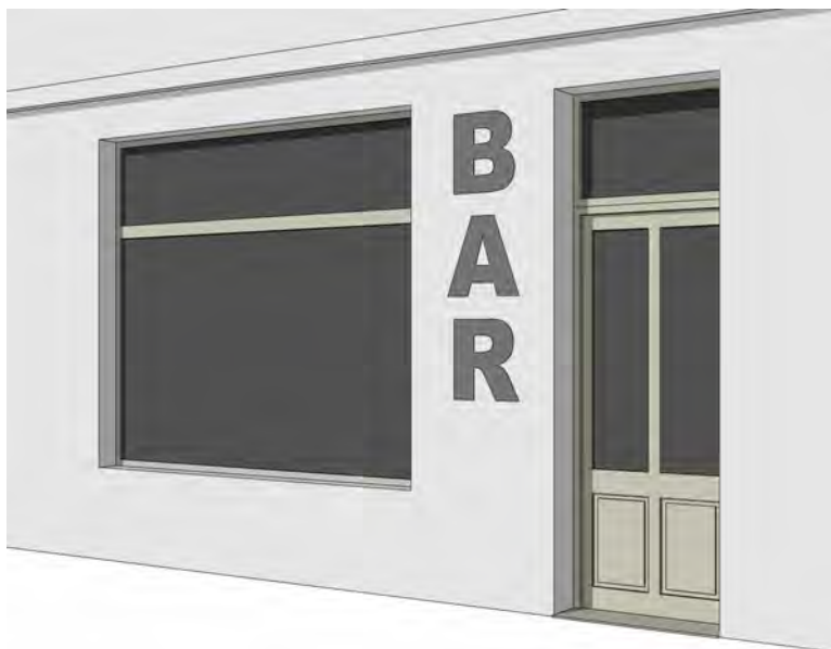
Rys. Odmiana szyldu pionowego z liter malowanych
